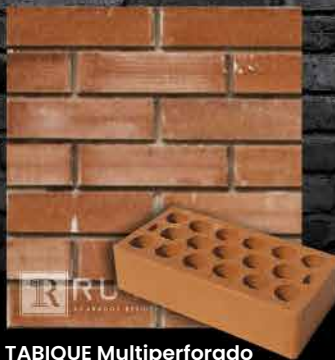
TABIQUE Multiperforado TAS • 24 x 6 x 12 cm. • 57 pzas/m 2 • 1.70 kg/pza.
