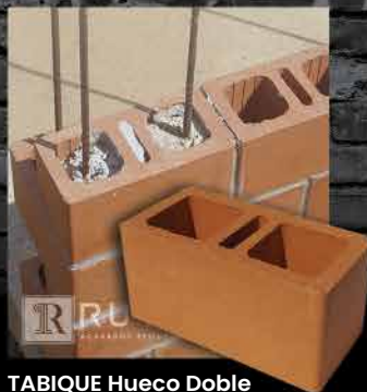
TABIQUE Hueco Doble 2VD • 24 x 12 x 12 cm. • 30 pzas/m 2 • 3.34 kg/pza
