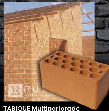
TABIQUE Multiperforado Doble TASD • 24 x 12 x 12 cm. • 30 pzas/m 2 • 3.40 kg/pza.
